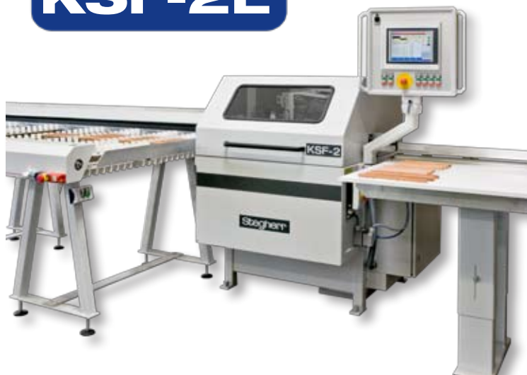
Cadre de fenêtre : coupe à 45°, entaille et perçage
