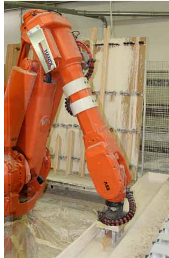
Einzigartig in Österreich: Roboterzelle für das Imprägnieren und Grundieren
