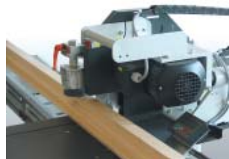
Zugsäge , zum Ablängen der Werkstücke. Max. Abmessungen: 180 x 100 mm
