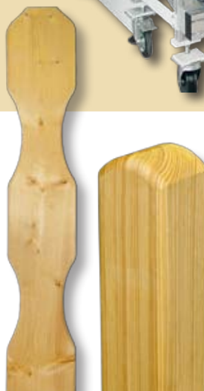
Fraisage de lattes de clôture et de poteaux
