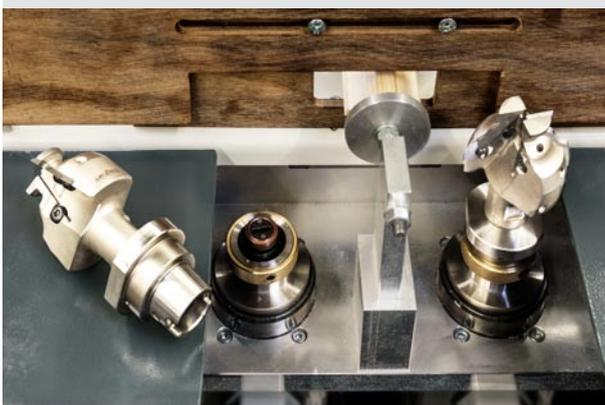
Durch einen optionalen, schnell verstellbaren Schwenkansschlag werden mit der Konterfräse KF-mini die Werkstückenden auch für Winkelanbindungen im Bereich von -45 Grad bis + 45 Grad sauber gekontert.
