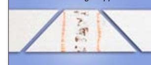
Fehlstelle wird ausgekappt
